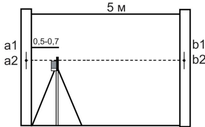
**Проверка точности горизонтального луча (изгиб плоскости)**
