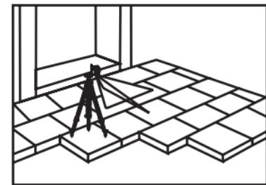
**Проверка точности лазерного построителя плоскости****Проверка точности лазерного построителя плоскости (наклон плоскости)**
