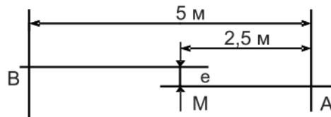
**Проверка точности вертикального луча**
